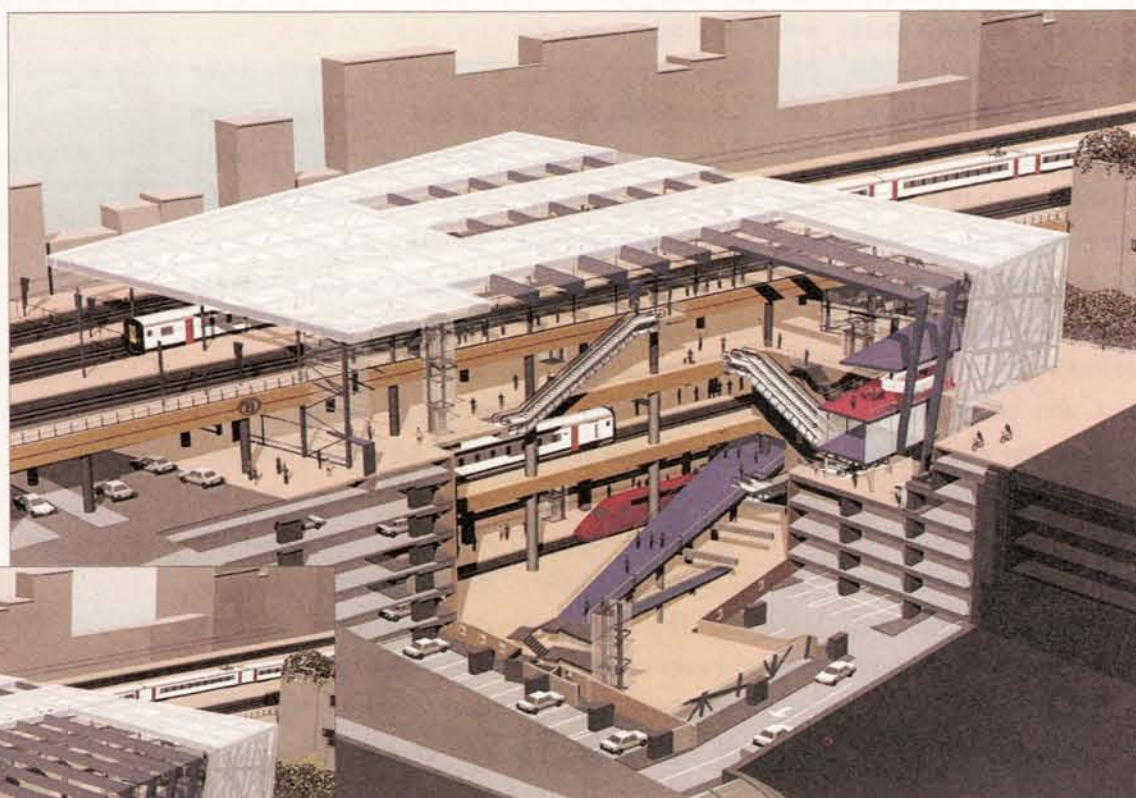
De stationstoegang krijgt een open structuur. De zijgevels zijn eigenlijk enorme poorten die in de winter voldoende beschutting bieden en in de zomer zorgen voor een briesje.
